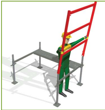
> 3 - Pose des échelles.
