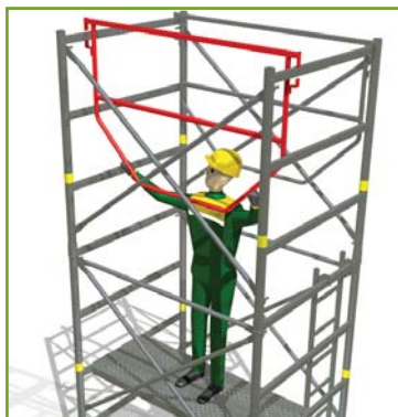
> 9 - Mise en place des garde-corps de montage.
