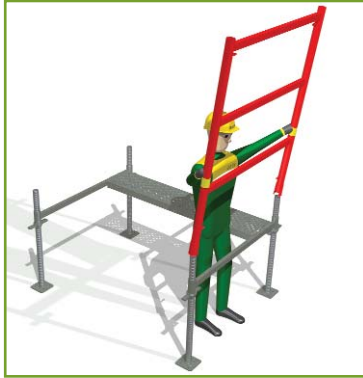
> 3 - Pose des échelles.
