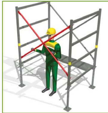
> 4 - Mise en place des croisillons.
