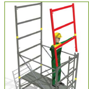
> 7 - Pose des échelles du niveau supérieur à partir du plancher inférieur. Verrouillage de l'échelle par chevilles.
