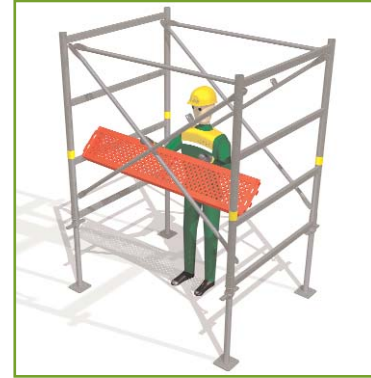
> 5 - Installation des 2 plançons à 1m sous les lisses garde-corps.
