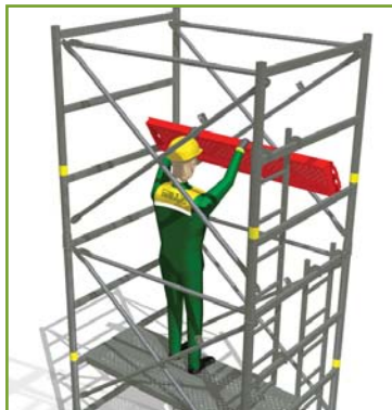
> 9 - Pour les niveaux intermédiaires, pose de 2 plançons alternés par rapport au niveau inférieur.
