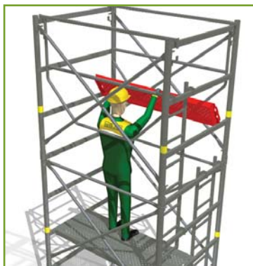
> 11 - Pour les niveaux intermédiaires, pose de 2 planchons alternés par rapport au niveau inférieur.
