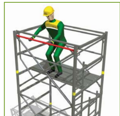
> 12 - Pose des lisses garde-corps puis répéter les opérations - vues 7 à 12 - jusqu'à la hauteur souhaitée.
