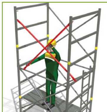
> 8 - Mise en place des croisillons du niveau supérieur.
