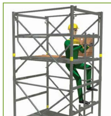
> 13 - Au dernier niveau, pose d'un cadre à trappe et d'un planchon.
