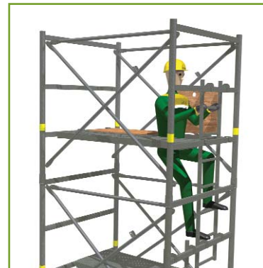
> 10 - Au dernier niveau, pose d'un cadre à trappe et d'un plançon.
