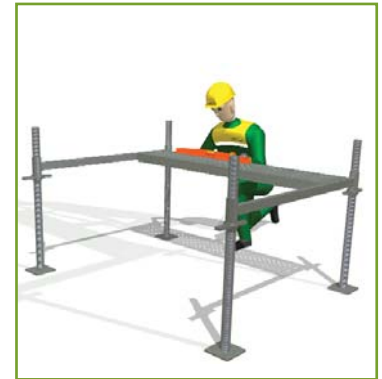
> 2 - Mise à niveau des 2 traverses basses. Utiliser un planchon en appui sur les 2 traverses.
